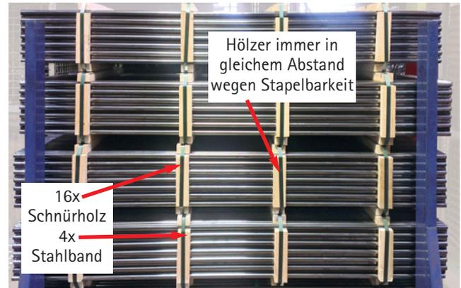
▶ Abb. 15 Stahlrohr, Fixlängen – Bunde von der Seite
